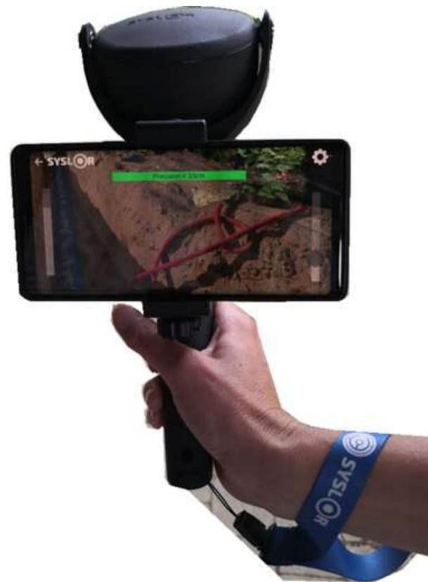
Antenne GNSS Syslor avec Smartphone
